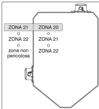
Durante l'installazione, l'uso e la manutenzione, è opportuno evitare qualsiasi carica elettrostatica, ad esempio: proteggendo lo strumento dal flusso d'aria diretto, pulendolo con panni umidi, collegandone a terra l'involucro. L'indicatore di livello può essere fornito (su richiesta) con un connettore circolare M12, montato sull'ingresso cavi da G 1/2 (BSPP) e dotato di 3 (tre) o 4 (quattro) pin per il collegamento del cablaggio sul campo.
