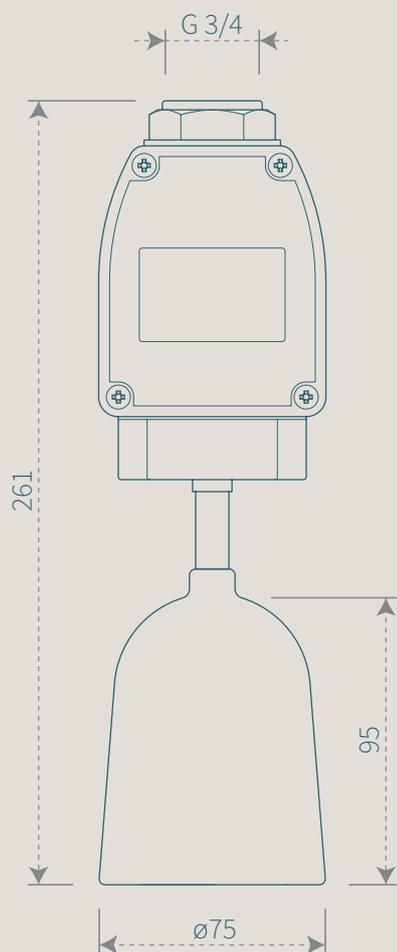
Montaje mediante suspensión de tubería
